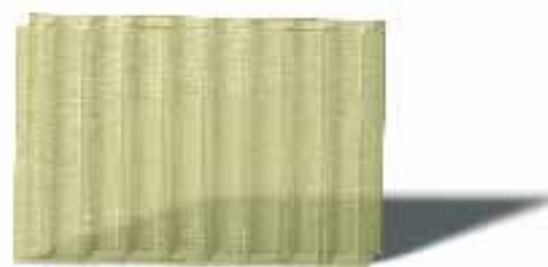
Amostra 3 - \Delta Y_i = 10 - Garantia da chapa de PC alveolar típica
